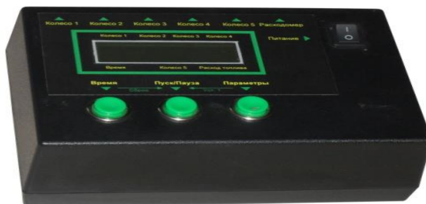
Рис. 2. Шестиканальный счетчик импульсов.
