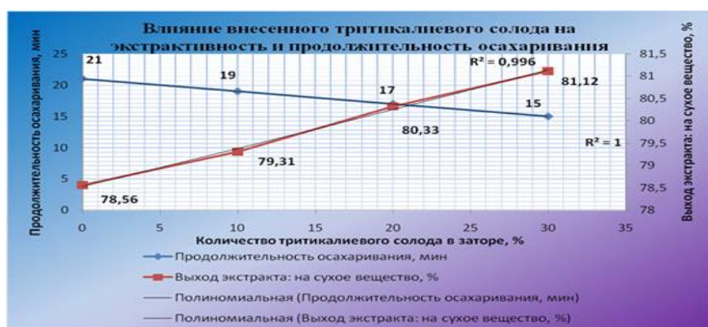
Рисунок 2 – Влияние количества тритикалиевого солода на экстрактивность и продолжительность осахаривания при настойном способе затирания
