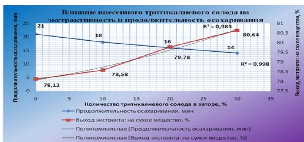
Рисунок 1 – Влияние количества тритикалиевого солода на экстрактивность и продолжительность осахаривания при одноотварочном способе затирания
